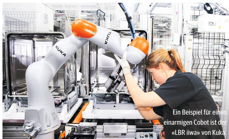
Ein Beispiel für einen einarmigen Cobot ist der «LBR iiwa» von Kuka.
